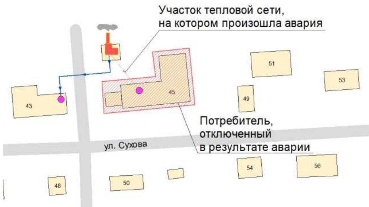
Рисунок 2.14 – Моделирование аварийной ситуации на котельной №15, с. Тюнгур, сценарий № 2
