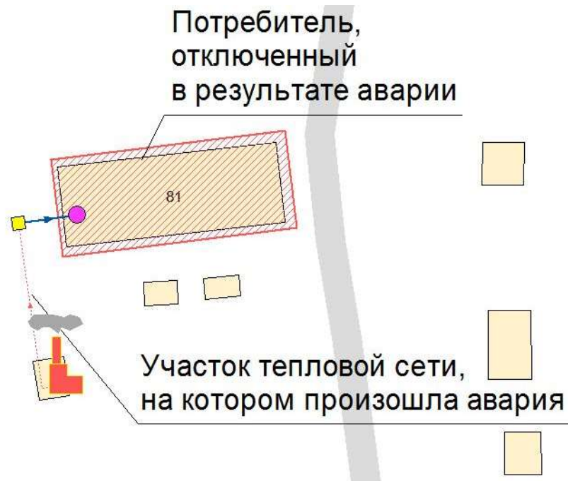
Рисунок 2.12 – Моделирование аварийной ситуации на котельной №14, с. Катанда
