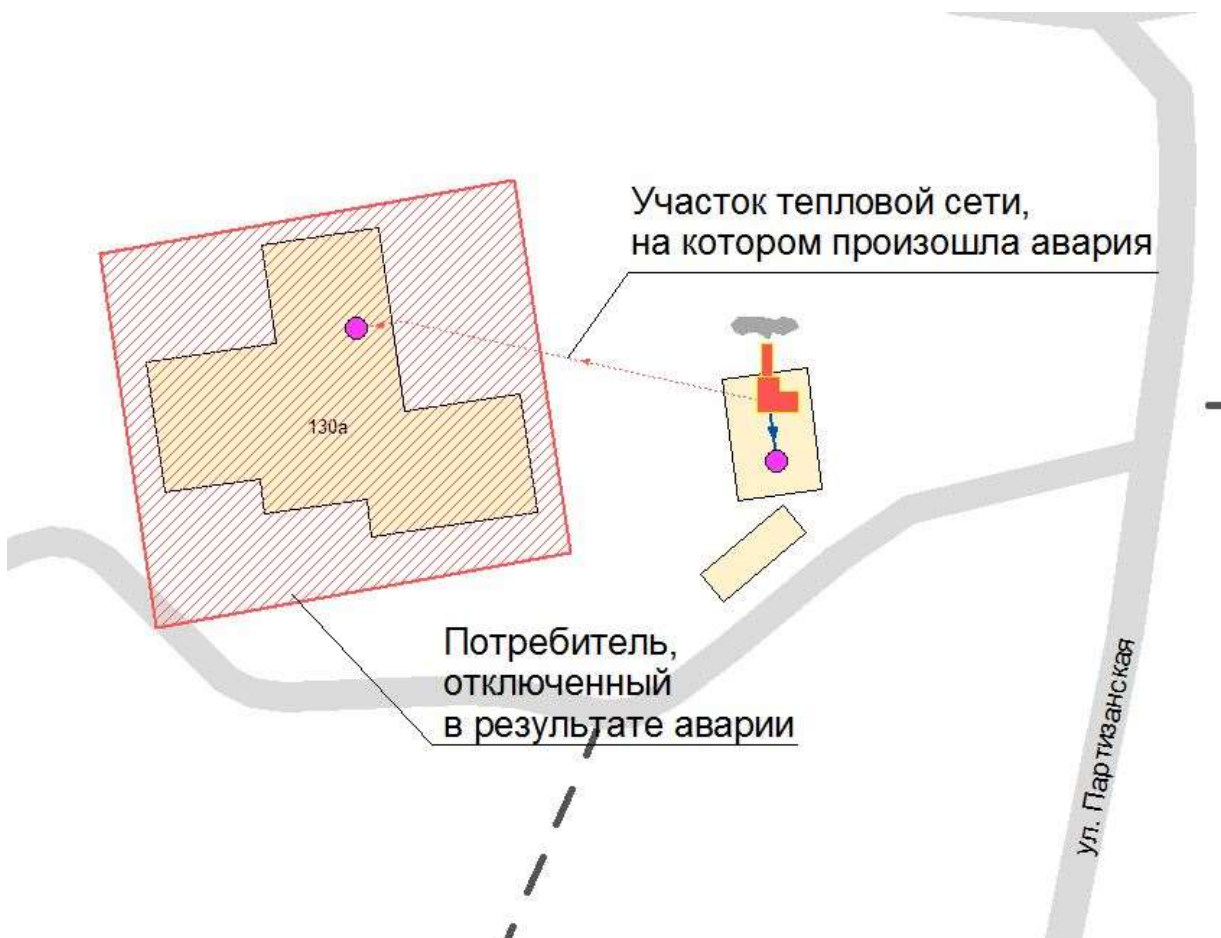
Рисунок 2.11 – Моделирование аварийной ситуации на котельной № 13, с. Катанда
