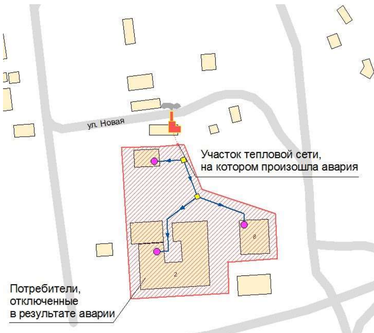
Рисунок 2.11 – Моделирование аварийной ситуации на котельной №9, с. Кайтанак
