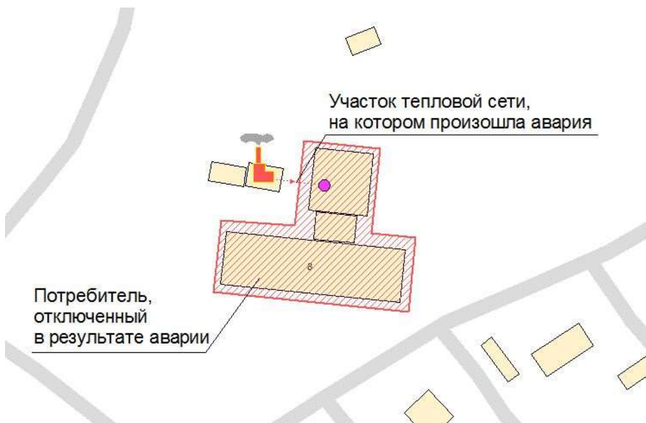
Рисунок 2.10 – Моделирование аварийной ситуации на котельной №8, с. Огнёвка
